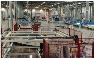
Bild 1: Digital bedruckte Fußbodenplatten auf ihrem Weg zum Auftrag des Decklacks. Während des gesamten Herstellungsprozesses werden Farbe und Lacke mittels UV ausgehärtet.
