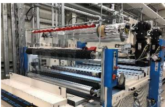
Bild 2: Im Calander-Coating-Inert (CCI)-Verfahren wird der aufgetragene Lack durch eine Folie hindurch unter Inert-Bedingungen ausgehärtet.
